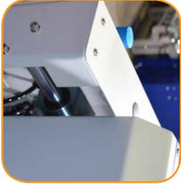
Réglage de la largeur du carton avec une manivelle
