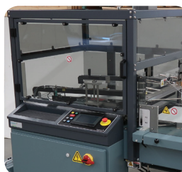
Nouveaux carters avec circuit de sécurité à double surveillance
