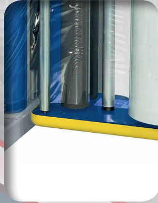
ARRESTO DI SICUREZZA ALLA BASE DEL CARRELLO SAFETY STOP AT SPOOL CARRIAGE BASE
